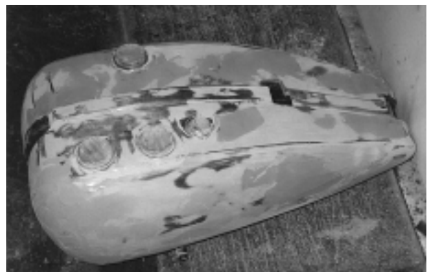
図9 燃料タンクの改修
