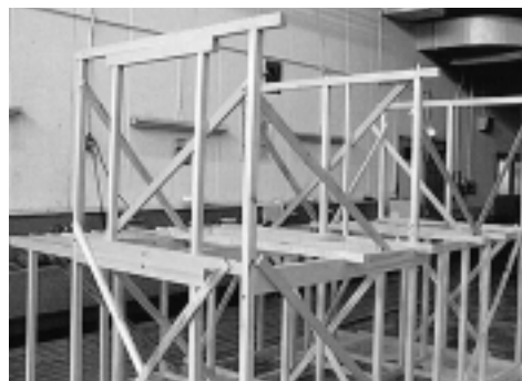
写真7 1/3縮尺構造模型（組立の例）
