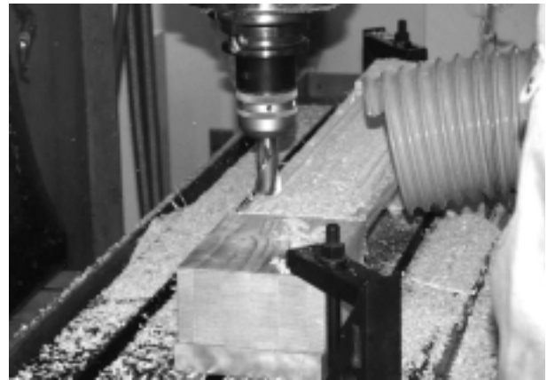
図2 翼の加工風景
