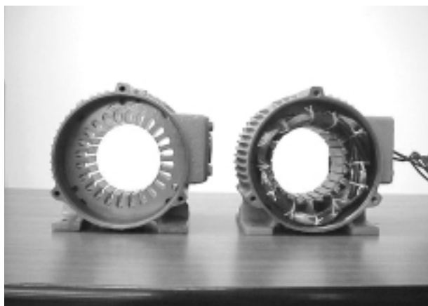
(a) 誘導モータの固定子（左：巻線なし，右：巻線あり）
