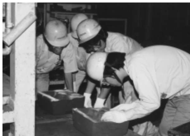
写真4 砂型造型・鋳造実習
