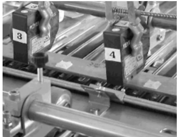
写真3 レーザー式距離センサによる計測
