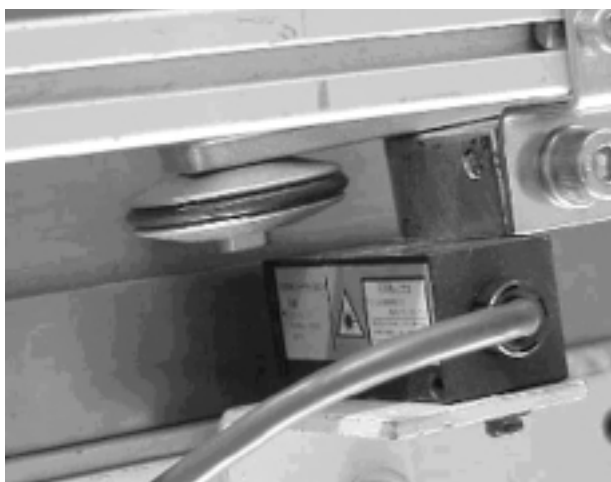
写真2 紙の側端位置を検出する光センサ
