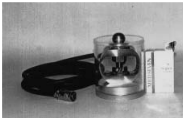
図4 「市販品の2倍の感度を有するロードセルの製作」（ロードセルの外観とその性能表）（1994年度実施）
