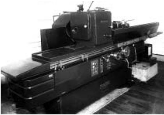
図4 精度向上完了後のエキセルオねじ研削盤50型
