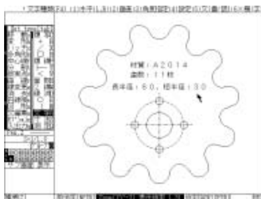
図2 CADによるマーキングデータの作成
