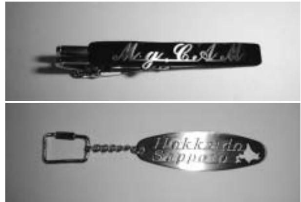
図9 ワイヤカット加工品例
