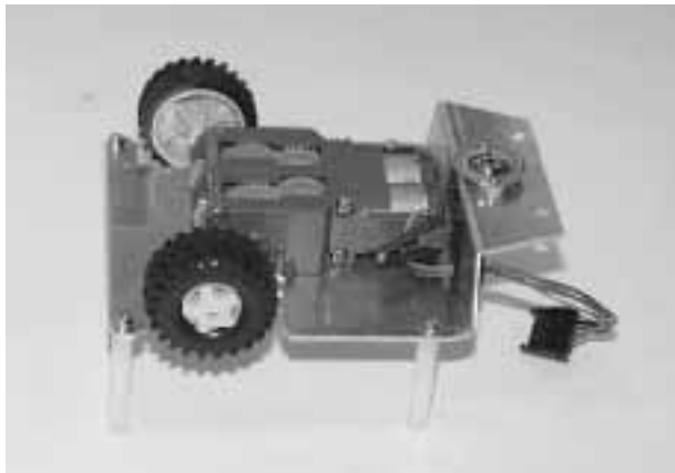
図4 完成したシャーシおよび駆動部
