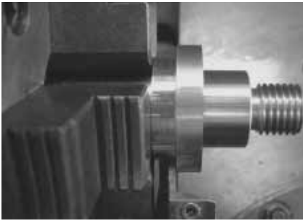
図5 第2回工程表による加工写真（工程表⑥-2に記すように、溝入れバイトで側面切削することによりツバ両側面の平行度が保たれる。）
