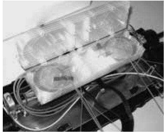
図13 光ファイバ収納状況(1)
