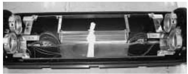
図14 光ファイバ収納状況(2)
