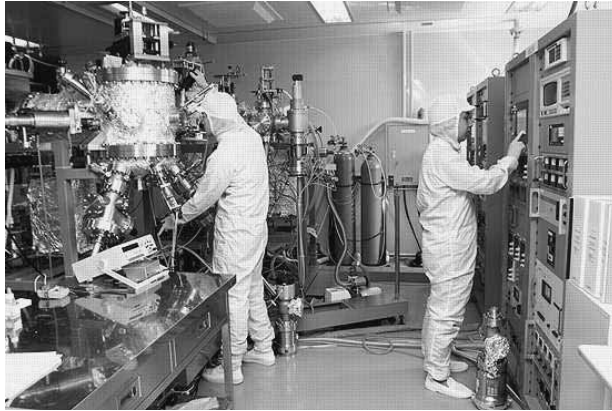
写真2 分子線エピタキシー装置 (MBE) 操作風景
