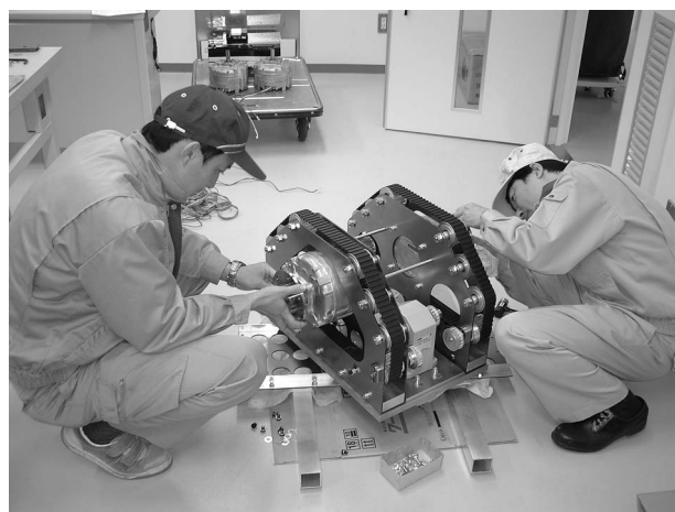
図2 車両組み上げ作業風景
