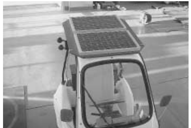
写真9 ソーラーパネル設置
