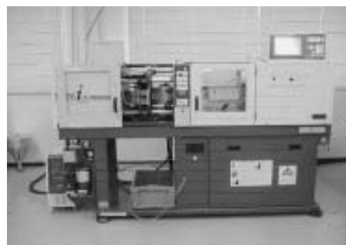
図15 射出成形機の外観
