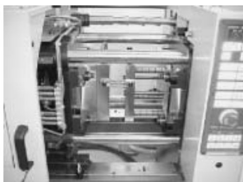
図16 型圧調整およびドライラン
