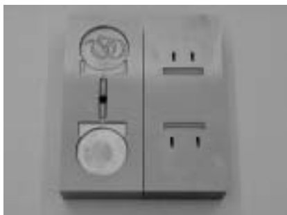
図13 入れ子加工例（スライド式2プレート金型）
