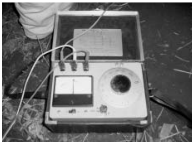
写真5 接地抵抗確認
