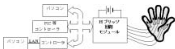
図10 ハンドロボット制御ブロック図
