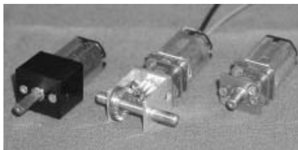
図3 超小型精密ギア・モータ栄42とギアの組み合わせ
