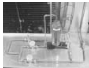
図11 受液器効果確認実験装置
