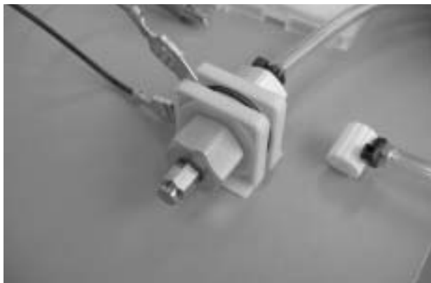
図3 燃料電池組立キットのPEFC
