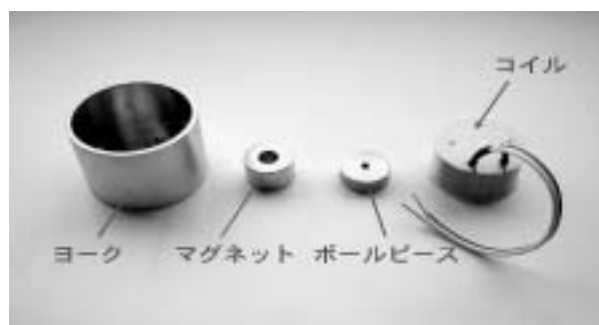
図4 試作したコイルモータ
