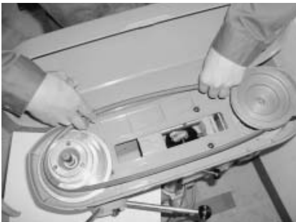
図6 Vベルトの架け替え作業
