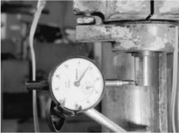
図2 主軸の振れ測定
