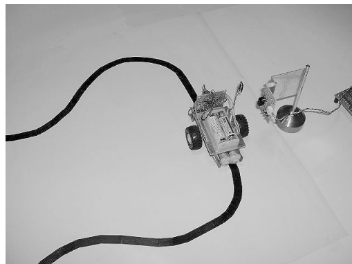
図2 トレースロボットの走行試験
