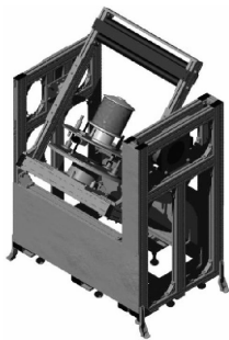
写真1 三次元CAD設計W1350×D800×H1900, 装置重量：3500N, 企業配光測定室設置運用テスト
