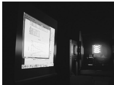
写真1 三次元CAD設計W1350×D800×H1900, 装置重量：3500N, 企業配光測定室設置運用テスト
