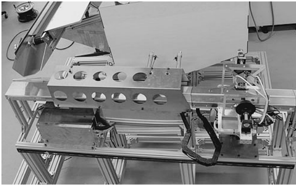
図12 待機レーン(左側)とソケット方向判別部(右側)の全景
