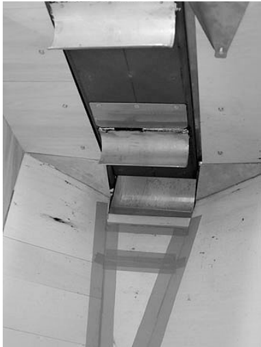
図5 バケット内部と取り出し用アーム
