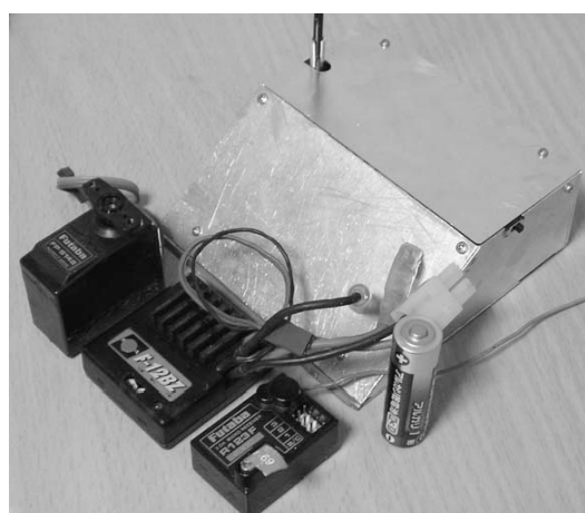
市販のサーボ、アンプ、レシーバと小型ロボットの比較
