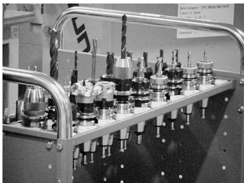
②生産工程CAMシステム：CNCフライス盤，工具の選定，適切な加工条件と加工順序
