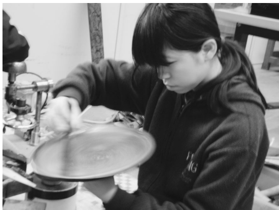
写真1 第7工程：辺掛け
