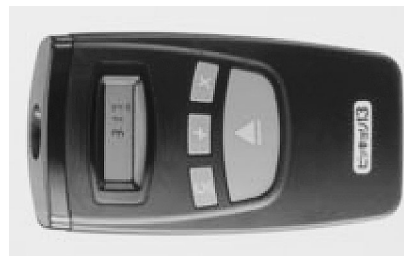
図2 市販の超音波距離計
