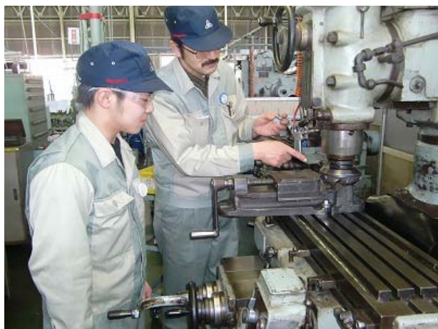
写真7 被訓練者のOJT訓練（フライス盤加工）
