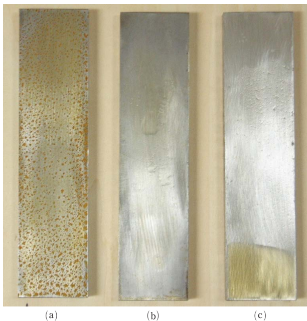
図9 型枠の腐食状況
