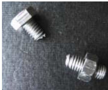
ボルトの折損
