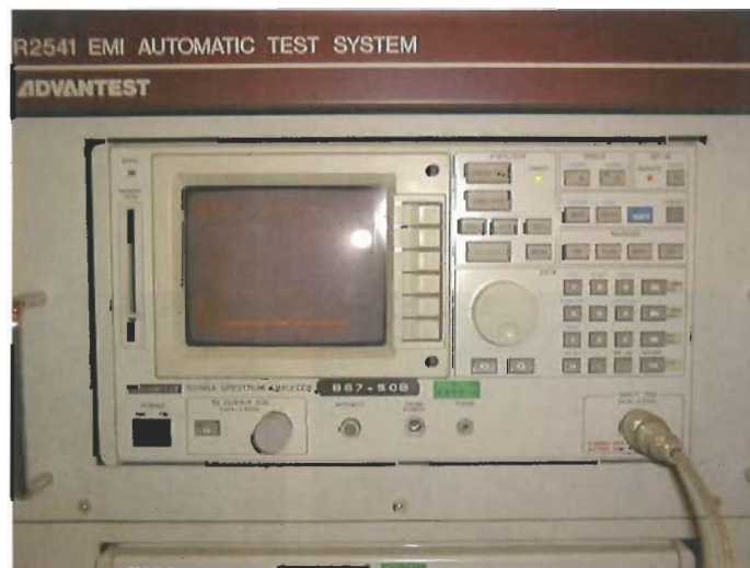
図5 スペクトラムアナライザの例
