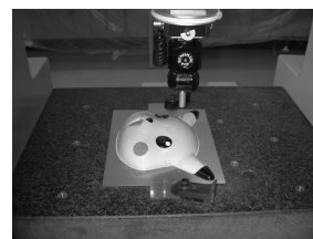
図7 三次元測定機によるデジタル化
