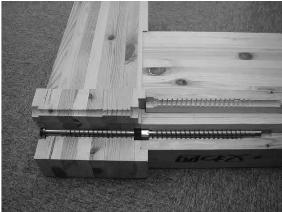
写真11 接合状況 (材をカット)
