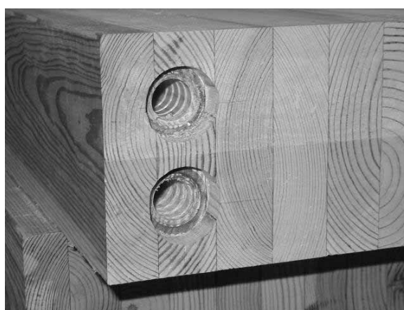
写真24 梁材のねじ切り加工
