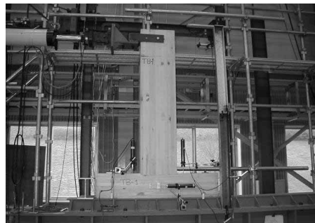
写真7 柱・梁接合部の曲げ試験
