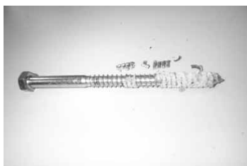
写真1 ラグスクリーの引抜後
