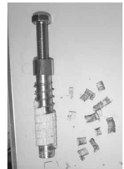
写真3 試作品の引抜後 (繊維方向)
