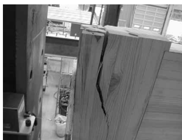
写真15 柱の引張割裂破壊
