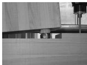
写真10 TB - 3梁材の割裂後の梁側引抜
