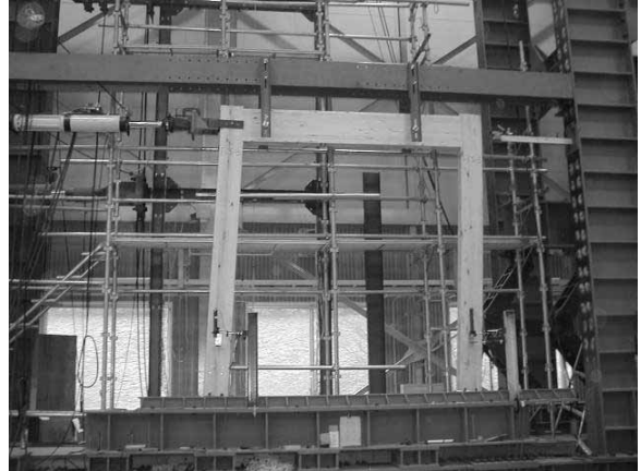
写真12 フレーム水平加力試験 (スパン2 610mm)
