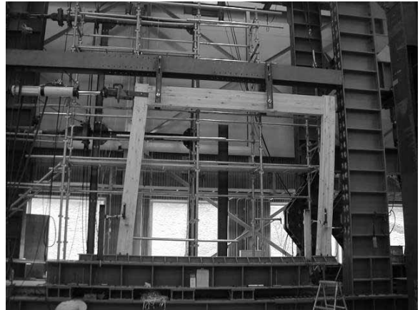
写真13 フレーム水平加力試験 (スパン3 520mm)
