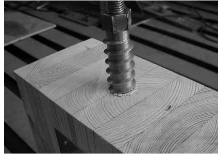
写真5 接合具の引抜き試験 (繊維方向)
