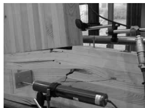
写真8 TB - 1柱材の横方向引張割裂
