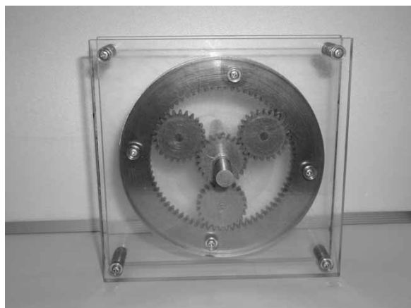
図9 遊星歯車機構 太陽歯車、遊星歯車 モジュール1.5 歯数24 圧力角 20^\circ 内歯車 モジュール1.5 歯数72 圧力角 20^\circ
