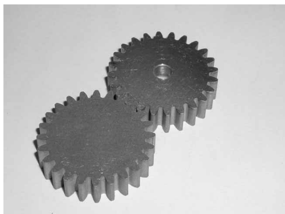
図8 アルミニウム製歯車 モジュール1.5 歯数24 圧力角 20^\circ
