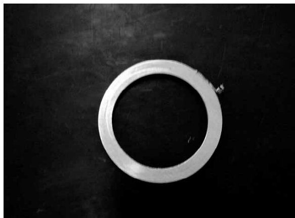
写真2：パイプ切断面に発生したバリ
