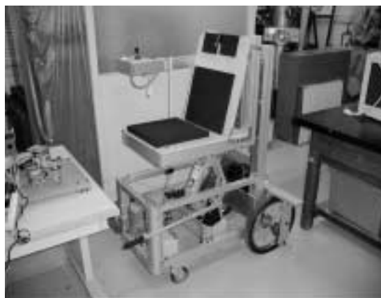
図9 座面昇降装置付き電動車いすリフトアップ状態
