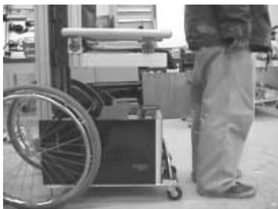
図7 昇降装置付車いすによる立ち上がり動作
