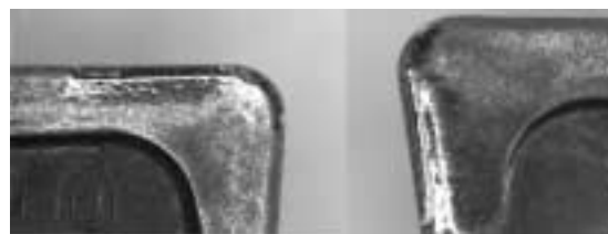
図12 中仕上加工チップ摩耗状況
