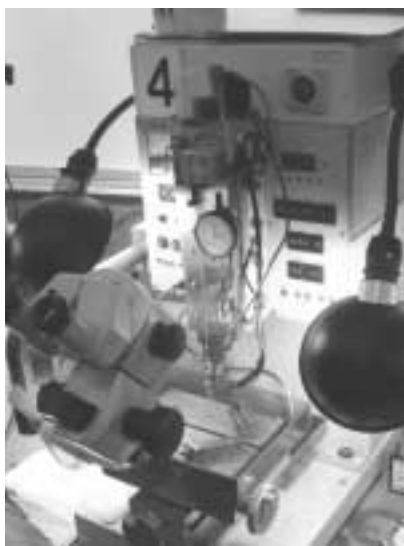
図1 現在の微小孔放電加工機の外観
