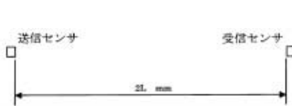
図11 透過法のセンサ配置
