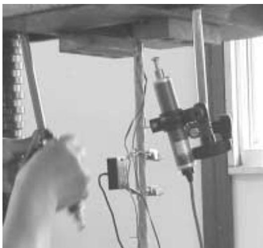
図9 伸び計（中央）と変位計（右）
