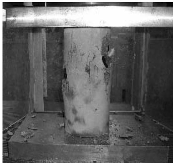
図7(a) 材齢一週目供試材（粉砕形状：15mm）
