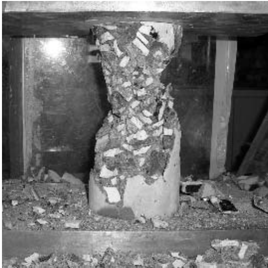
図7(b) 材齢四週目供試材（粉砕形状：15mm）
