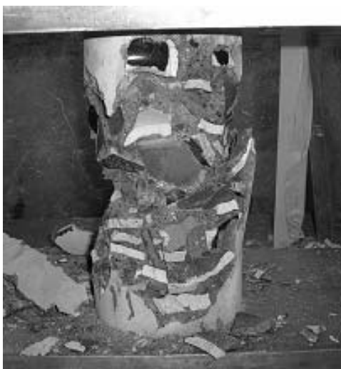
図8(b) 材齢四週目供試材（粉砕形状：25mm）
