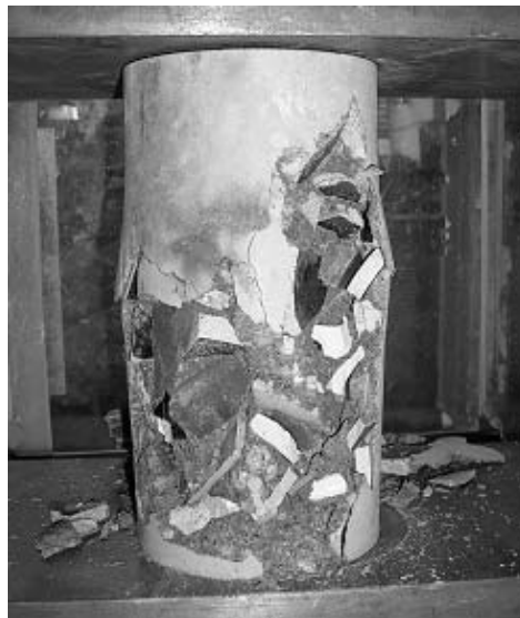
図11 材齢一週目供試材（混入率：75%）
