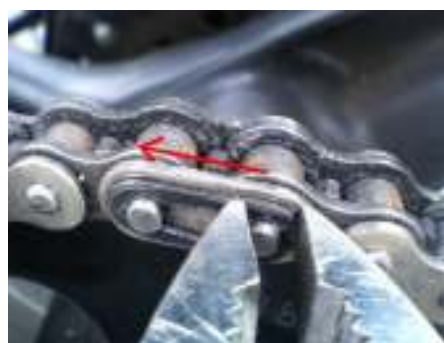
クリップによってチェーンが連結された状態
