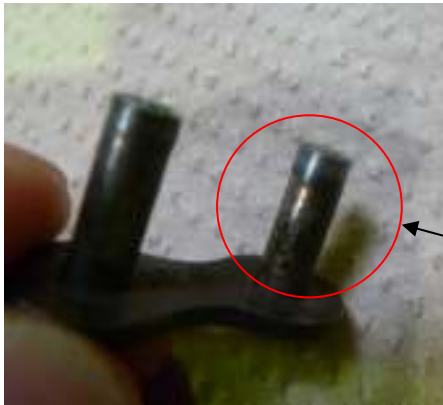
ピンの一部が摩耗した状態
