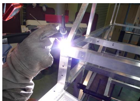
図4 製作風景「フレーム溶接」
