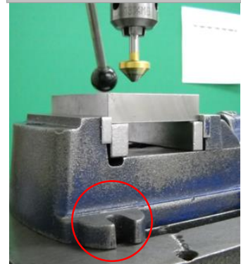
万力固定ボルトの取り外し
