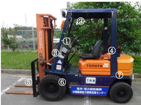
図4 実機カメラの設置位置
