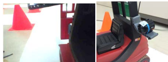
図6 RCのカメラ設置位置とその映像
