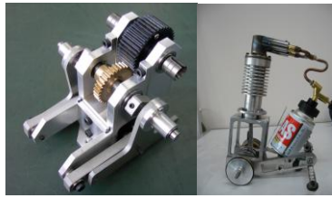
図2 クランク機構と β型スターリング エンジンカー
