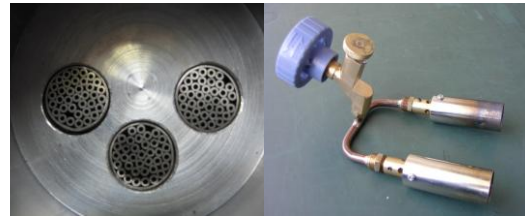
図3 ハニカムパイプ断面 と火口のロウ付け
