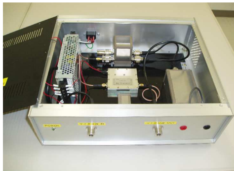
< マイクロ波高出力増幅器の外観および内部構成 >
