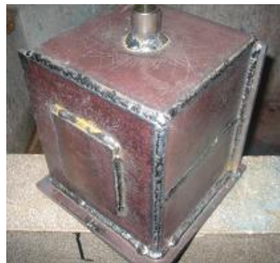
図4 水圧試験後の圧力容器
